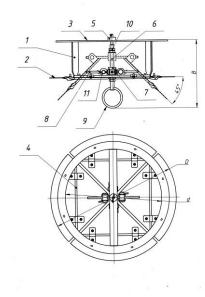
Рис. 1 Воздухораспределитель прямоточный
